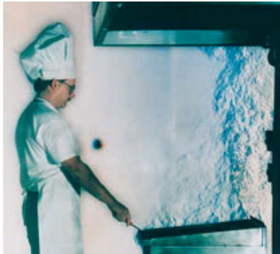
2. Thermische luchtstromen van keukenapparatuur in beeld gebracht met de 'schlierentechniek'.
